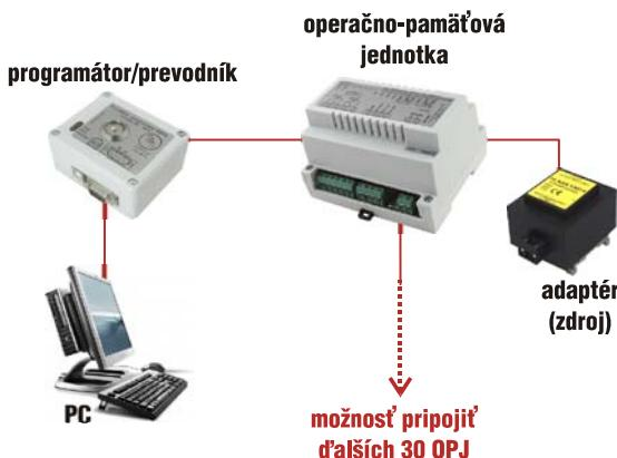
Prístupový systém DEK SIEŤ a BES umožňuje do siete zapojiť až 31 operačno-pamäťových jednotiek UNI SIEŤ, ktoré sú po naprogramovaní a pripojení na zdroj schopné pracovať aj samostatne bez pripojenia na PC. Jednotlivé OPJ sú pripojené na prevodník paralelne.
