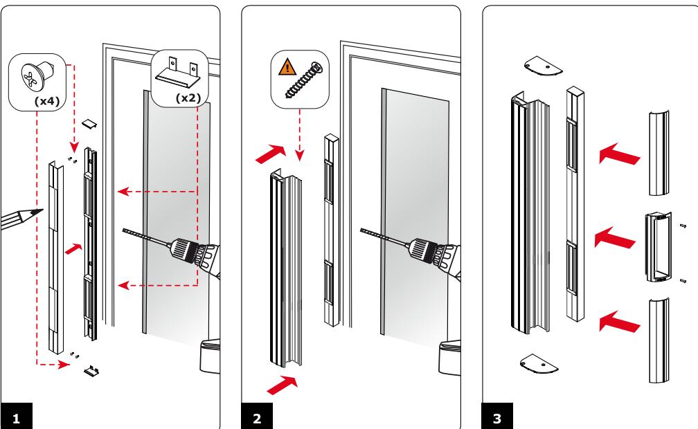
Priložte zadnú upevňovaciu lištu spolu s krytom s elektromagnetmi na dverový rám (alebo pevné dverné kŕidlo, ak inštalujete na dvojkridlové dvere) – ubezpečte sa, že pozícia lišty umožní dverovému madlu bezpečne prekryť lištu. Pokiaľ ste spokojní s umiestnením lišty, označte si vertikálne a horizontálne montážne otvory a vyvŕtajte ich. Poznačte si otvory pre vedenie vodičov a prestrčte vodiče.
